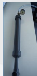
Bomba de vacío adaptada
