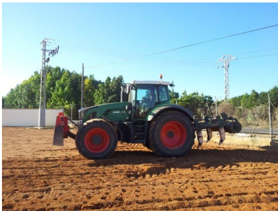
Figura 1. Labor de subsolado.
