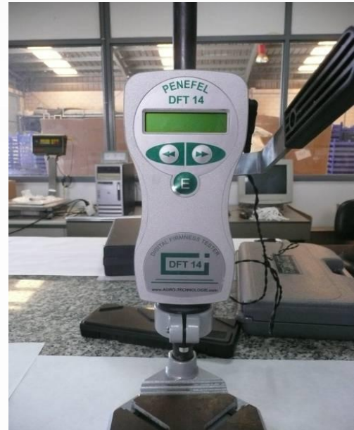
Imagen 3: Penetrómetro Penefel DFT 14 sobre soporte fijo
