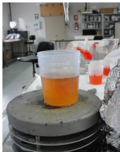
Imagen 6: detalle de la valoración ácido-base de la acidez
