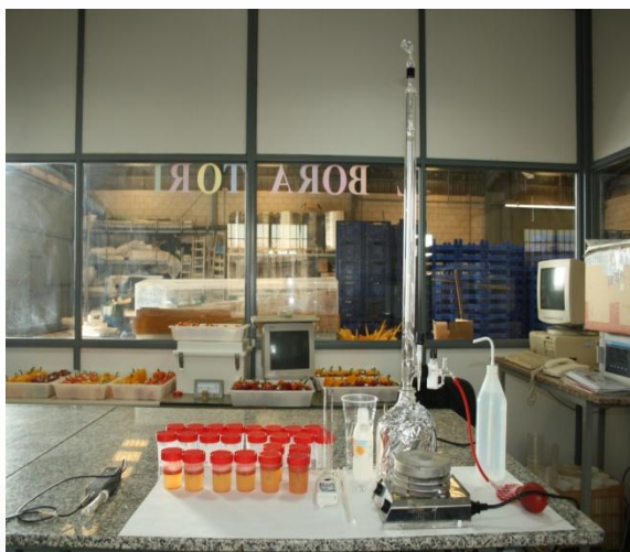
Imagen 5: titrador semi automatico para valoración de acidez
