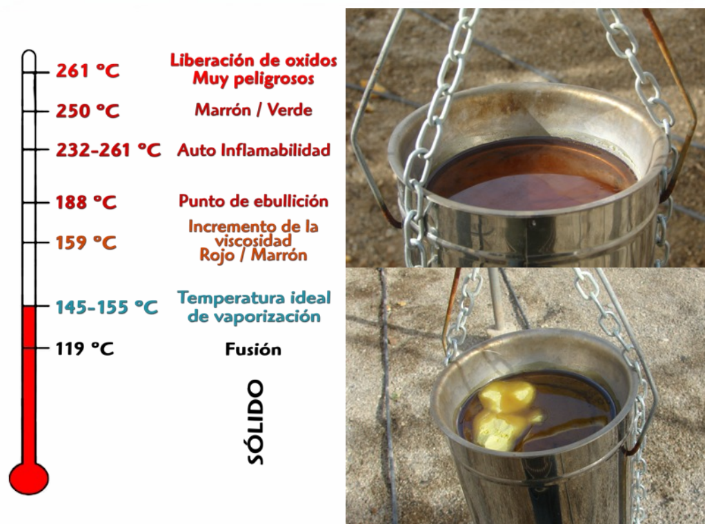
Figura 1: Temperaturas de funcionamiento en un sublimador
