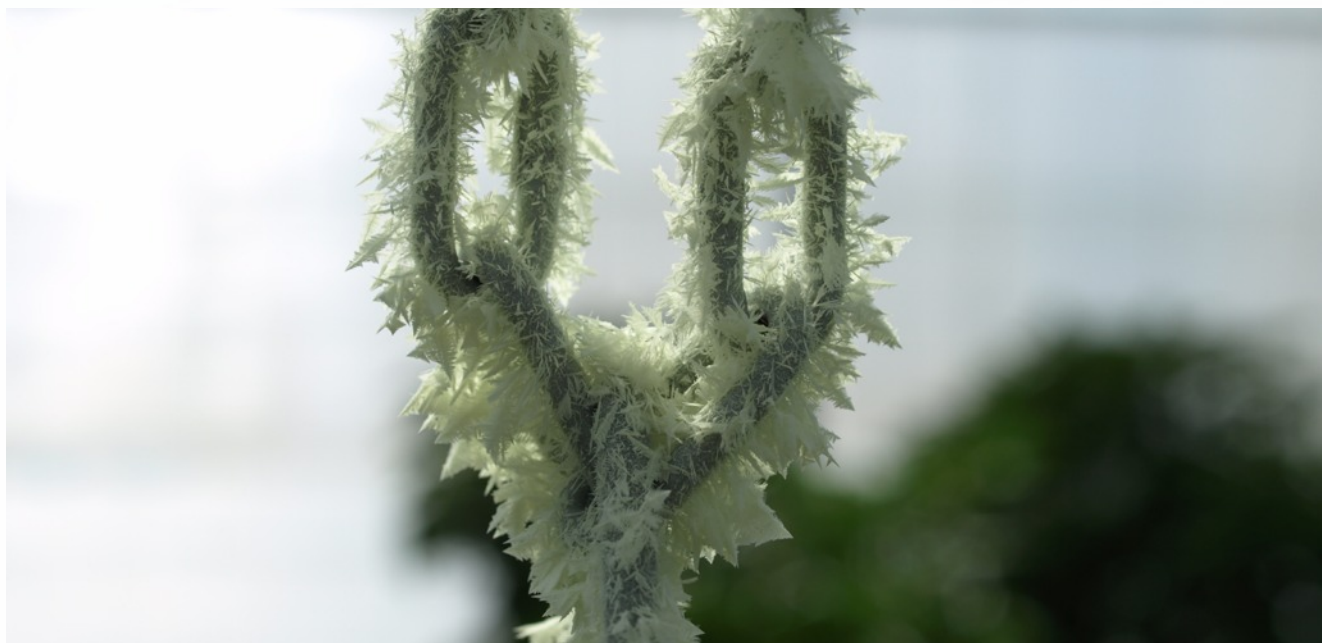
Imagen 7: Residuos acumulados en el soporte del sublimador
