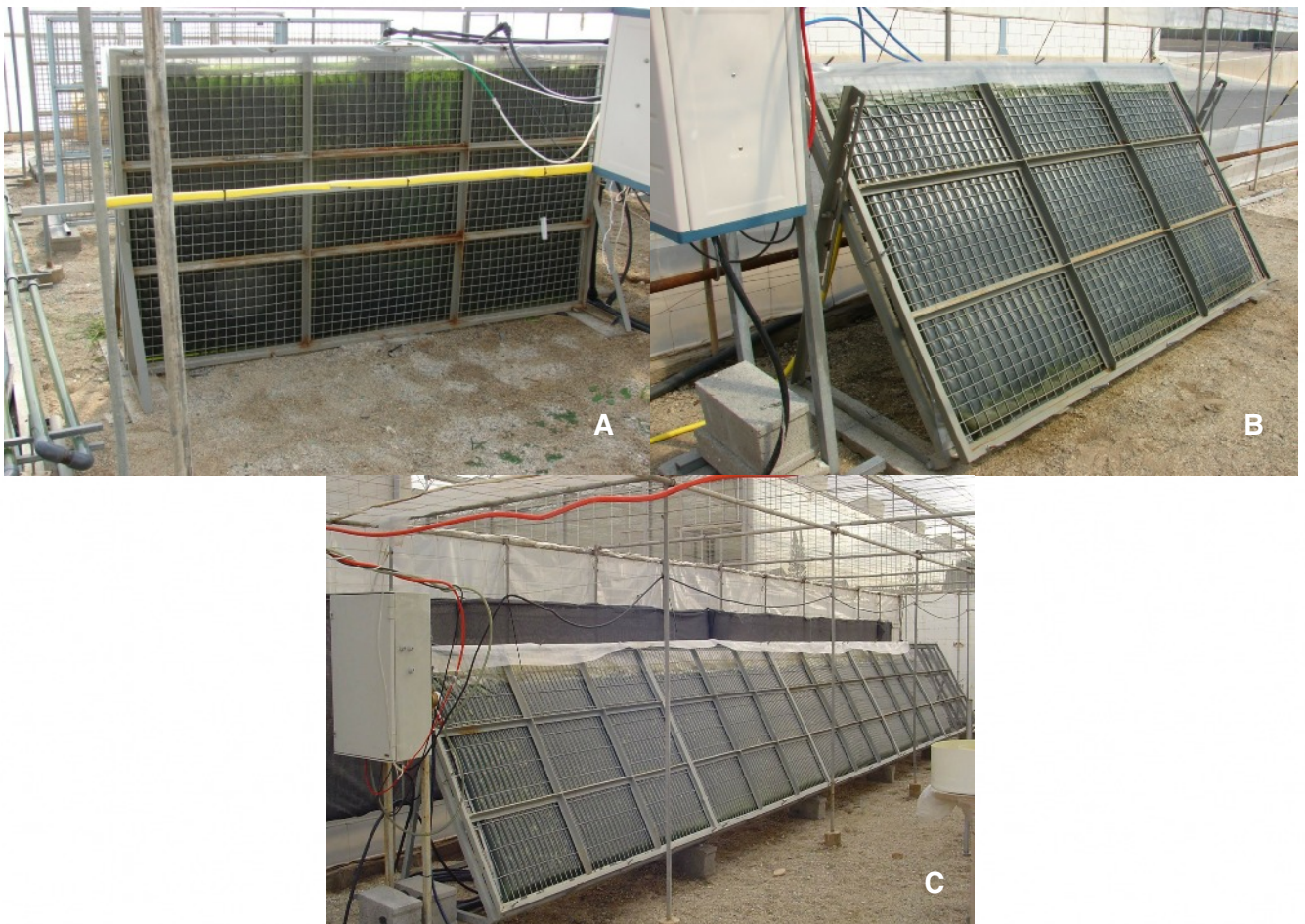
Imagen 8. Varios tipos de fotobiorreactores planos de lámina de plástico con marco metálico. A, fotobiorreactor plano vertical. B y C, fotobiorreactor plano en disposición inclinado con orientación sur un solo módulo o varios acoplados
