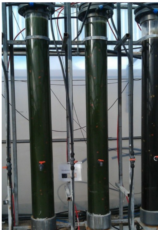
Imagen 7. Detalle de una columna de burbujeo para la producción de microalgas.
