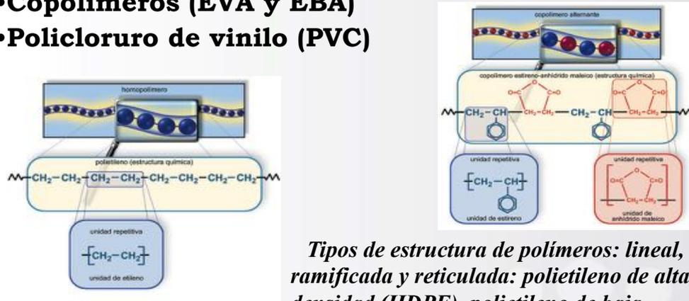
*Tipos de estructura de polímeros: lineal, ramificada y reticulada: polietileno de alta densidad (HDPE), polietileno de baja densidad (LDPE) y una resina fenol-formaldehído (PF)*
