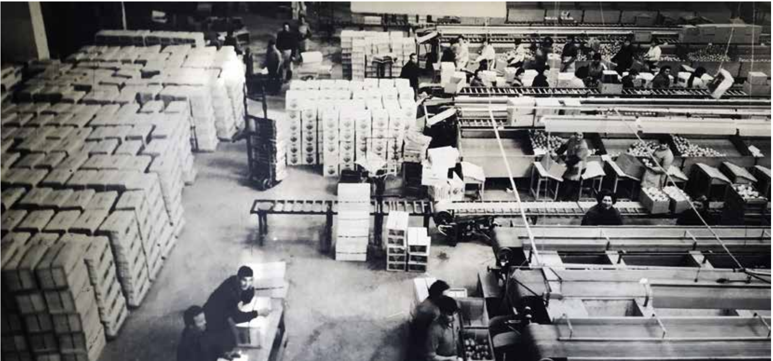
Instantánea que recoge la primera maquinaria instalada en la Cooperativa para efectuar el proceso de destrío y embalaje de las naranjas.
