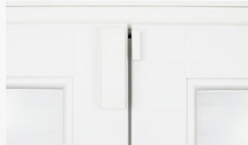
A través de sus sensores detecta vibraciones debido a golpes en los cristales.
